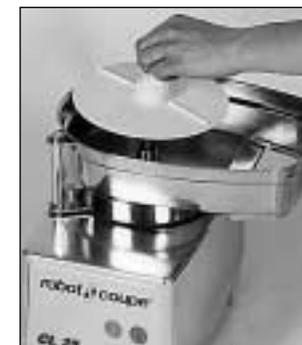
В зависимости от использования (Сторона А или В) снимите лоток диска-сбрасывателя со втулки, переверните и закрепите его на место.
